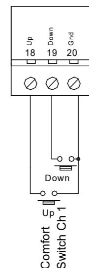
Rumtermostater, ugeure, CTS og andet eksternt styringsudstyr til komfortstyring kan tilsluttes på komfortstyringsindgangene.
